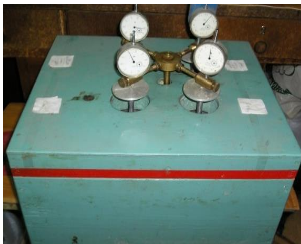
Рисунок Б.11 - Установка для определения степени пучинистости грунтов
