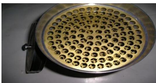
Рисунок Б.5 - Набор сит для определения зернового состава грунтов
