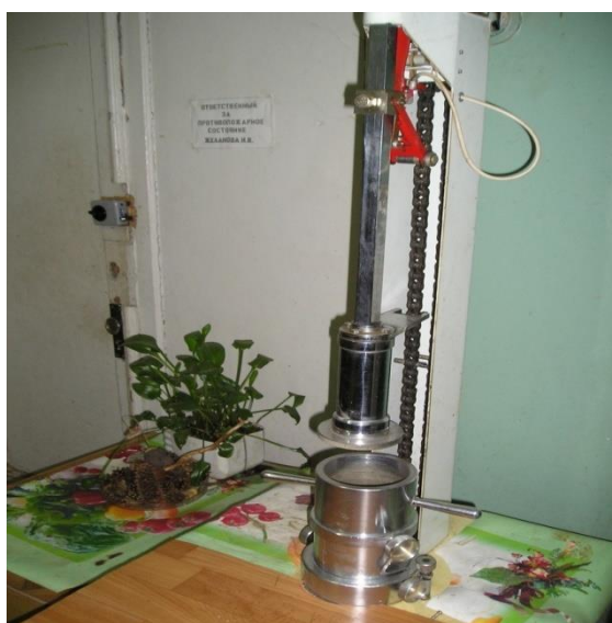
Рисунок Б.7 - Прибор стандартного уплотнения СоюздорНИИ
