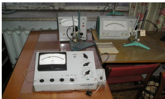
Рисунок Б.8 - pH-метр для определения pH водной вытяжки грунта и водного раствора полимерной эмульсии
