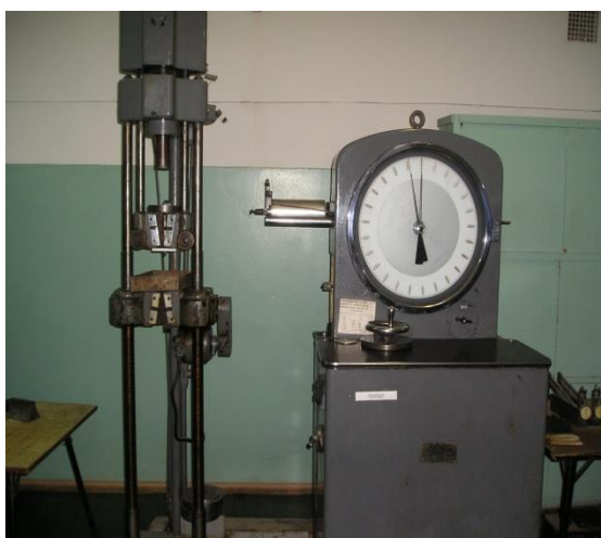
Рисунок Б.10 - Разрушающая машина для определения прочностных показателей стабилизированных, комплексно стабилизированных и комплексно укрепленных грунтов
