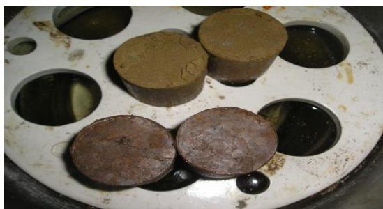
Рисунок Б.9 - Хранение образцов в эксикаторе
