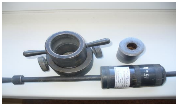
Рисунок Б.1- Малый прибор стандартного уплотнения
