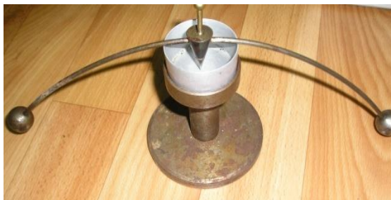
Рисунок Б.6- Конус Васильева для определения влажности на границе текучести
