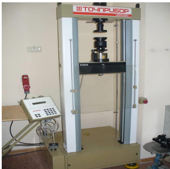
Рисунок Б.3 – Машина разрывная
