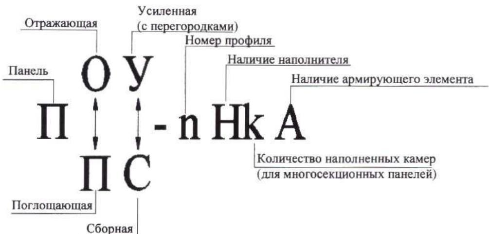
Рисунок 1 – Схема к расшифровке обозначения типа панели
