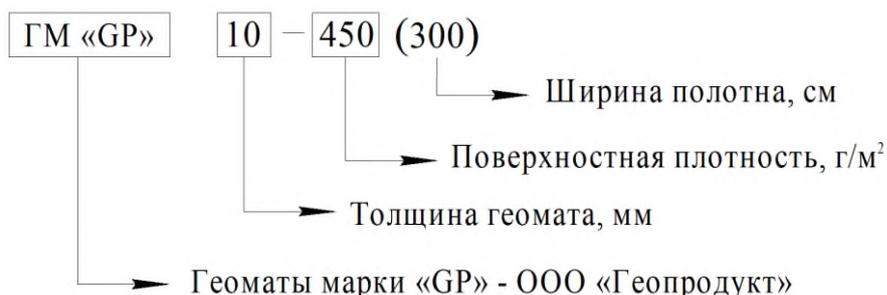
Рисунок 1 – Структура условного обозначения геоматов марки «GP»
