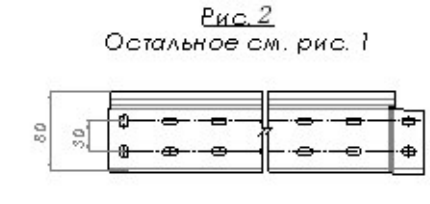
Высота 50 мм (тип SPH605) Рисунок Б.1.3.3 – Параметры перфорации лотков с шириной основания 150 мм длиной 6 м толщиной 2 мм
