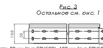
Высота 50 мм (тип SPH605) Рисунок Б.1.3.3 – Параметры перфорации лотков с шириной основания 150 мм длиной 6 м толщиной 2 мм
