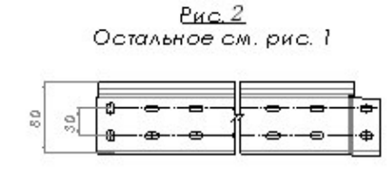
Высота 50 мм (тип SPH605) Рисунок Б.1.3.2 – Параметры перфорации лотков с шириной основания 100 мм длиной 6 м толщиной 2 мм
