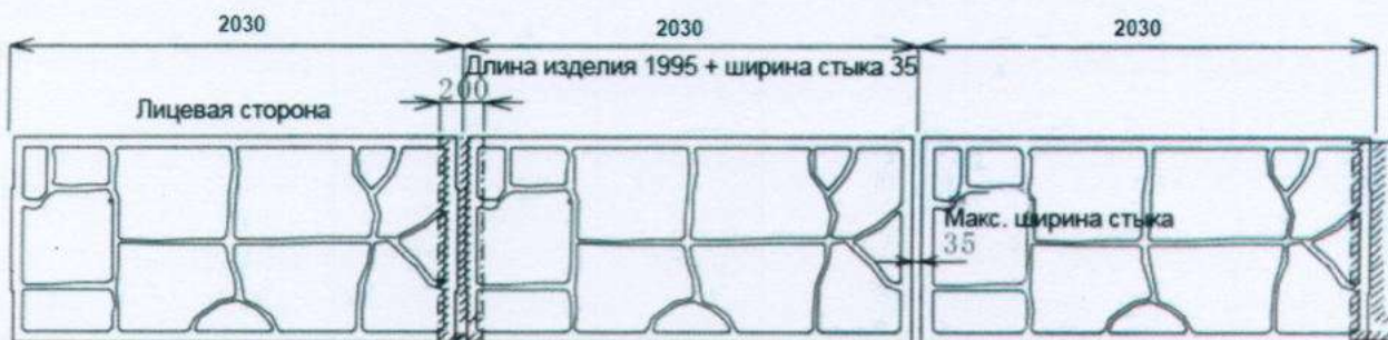
Рисунок 27 - Варианты регулировки длины шириной стыков.
