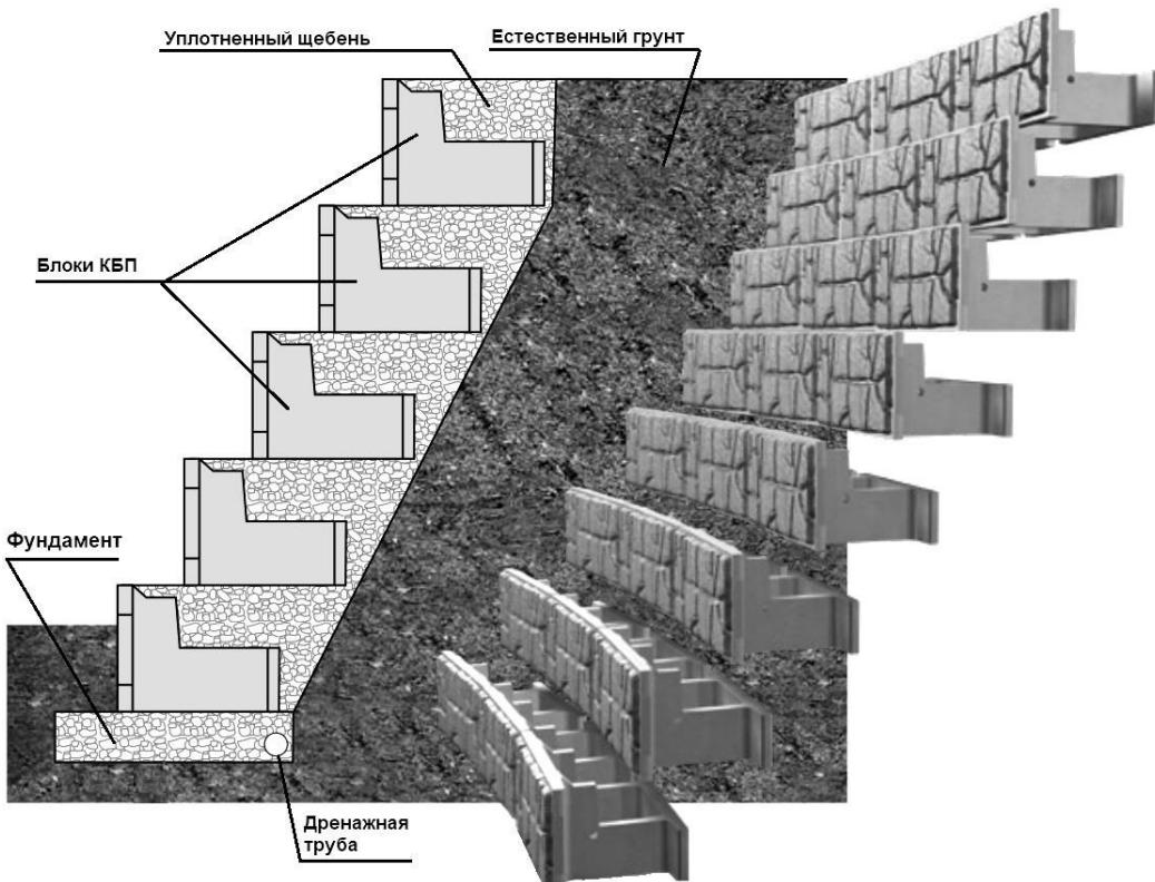
*Рисунок 1 - Общий вид устройства подпорных стен*
