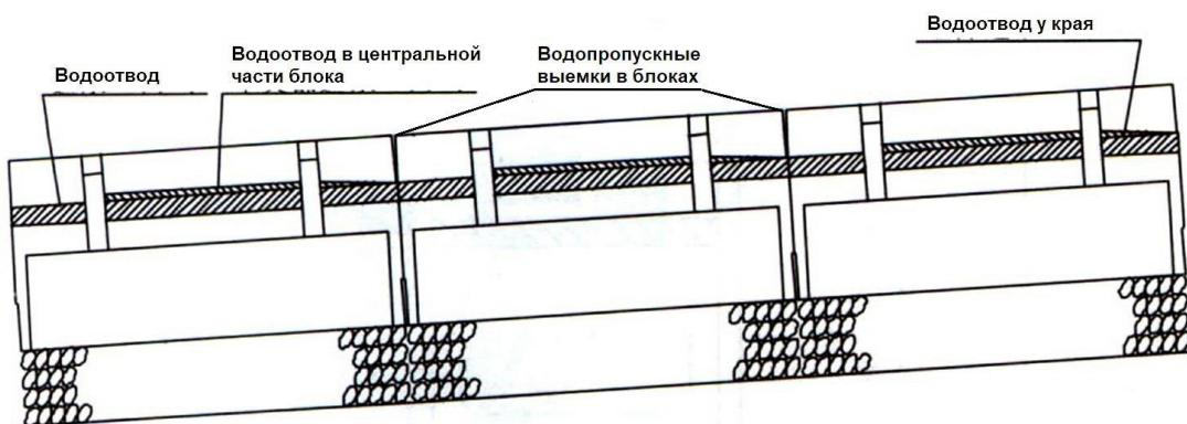
Рисунок 36 - Вариант водоотведения у края (вид сзади)
