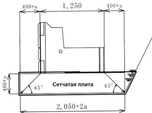
Рисунок 6 - Схема устройства габионно-сетчатой плиты (матрац Рено).
