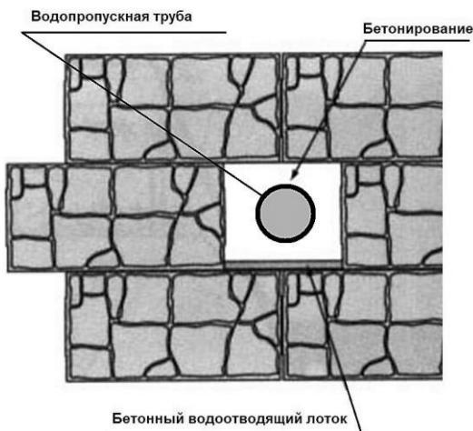
Рисунок 37 - Пример расположения водосливной трубы (с лицевой стороны).
