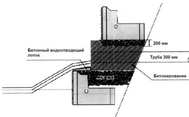
Рисунок 38 - Пример расположения водосливной трубы (вид в разрезе).
