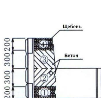
Рисунок 25 - Схема заполнения
