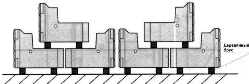
Рисунок 8 - Пример временного хранения готовой продукции.
