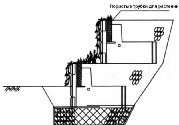
Рисунок 41 - Пример установки пористых трубок для озеленения.
