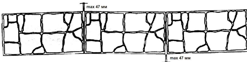
Рисунок 31 - Пример регулирования взаиморасположения блоков в точках изменения продольного уклона.
