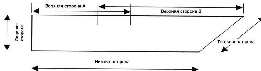
Рисунок 4 - Обозначения сторон стяжной сетки
