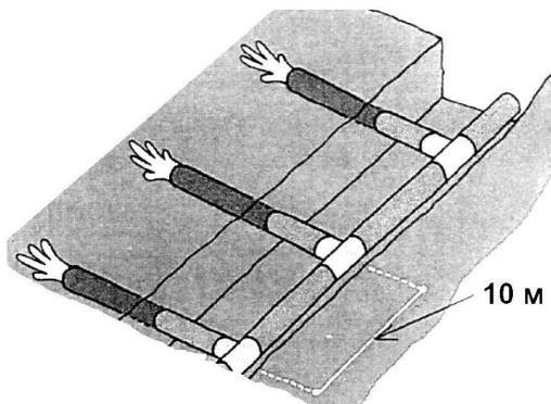
Рисунок 34 - Схема устройства поперечного выпуска дренажа
