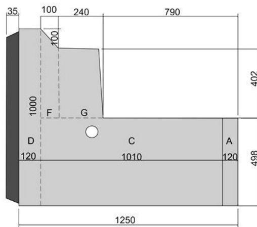
Рисунок А.1. - Блок конструктивный железобетонный КБП 100/200
