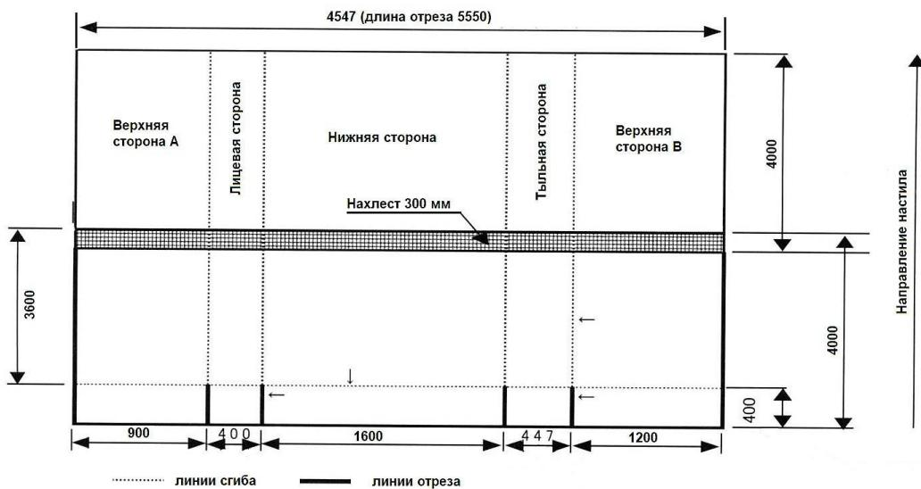
Рисунок 5 - Схема обработки краев стяжной сетки (для уклона 1:0,5).
