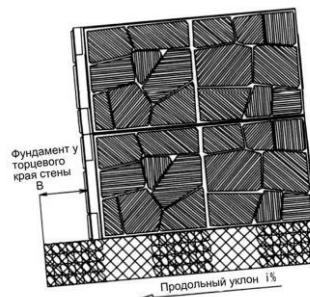
Рисунок 30 - Удлинение фундамента у края стены
