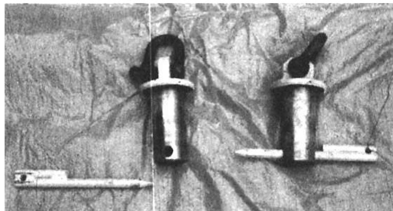
Рисунок 9 - Штыревые грузозахватные приспособления.
