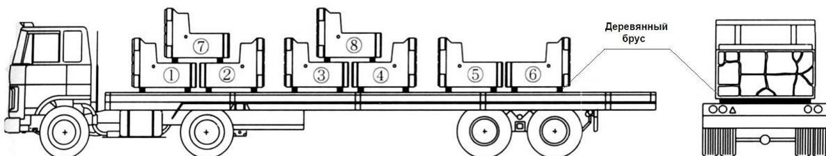
Рисунок 7 - Пример загрузки автомобиля грузоподъемностью 10 т (блоки КБП 200/100).
