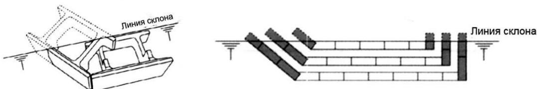
Рисунок 26 - Варианты заделки торцов стены.
