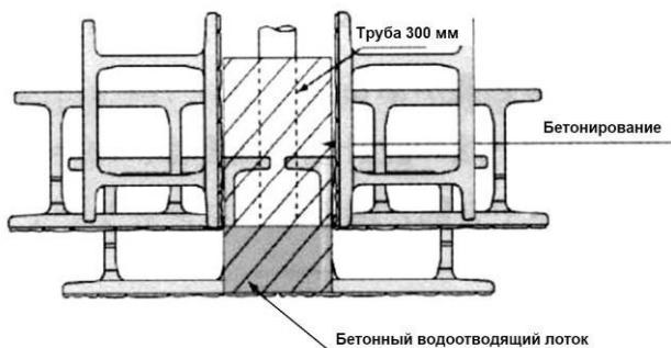
Рисунок 39 - Пример расположения водосливной трубы (вид сверху).
