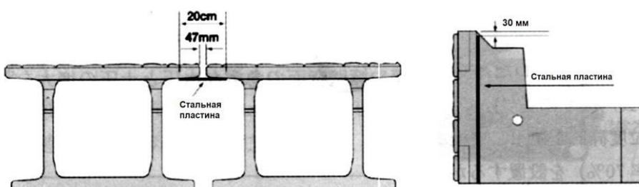
Рисунок 32 - Пример заделки зазора между блоками.
