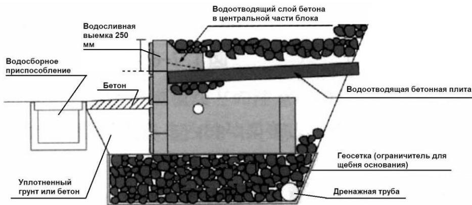
Рисунок 35 - Вариант водоотведения (вид в разрезе).
