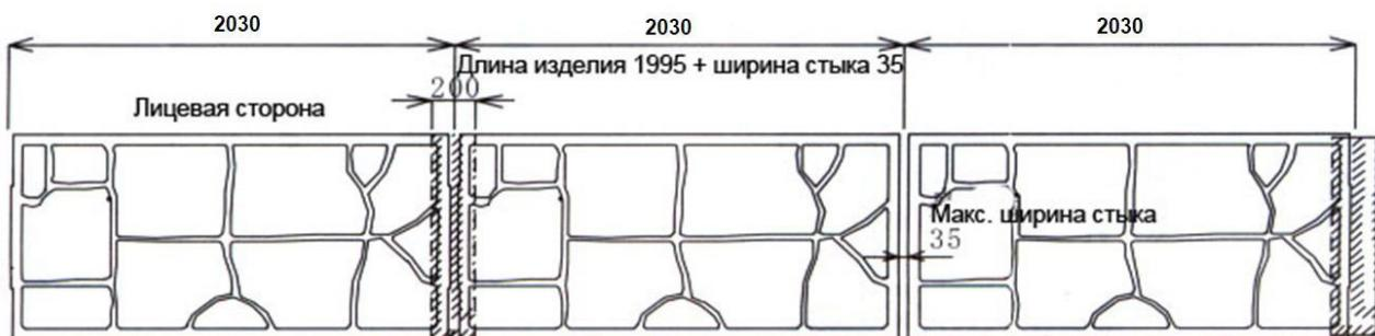
Рисунок 27 - Варианты регулировки длины шириной стыков.
