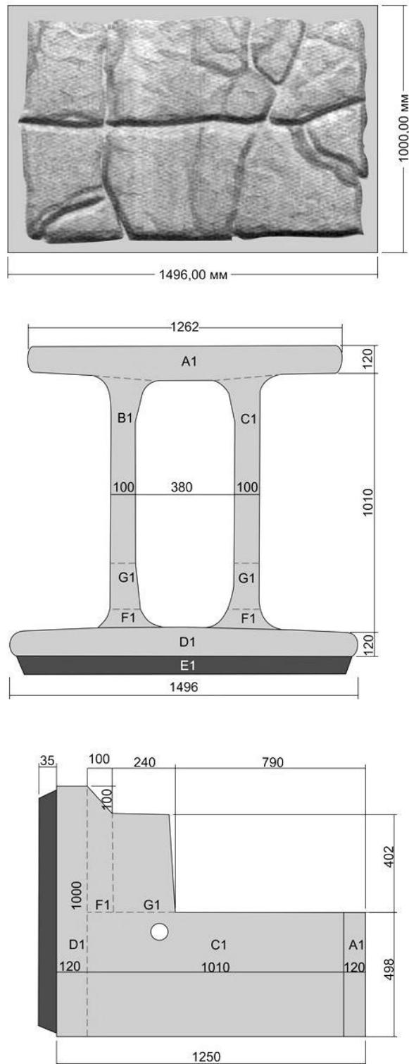
*Рисунок А.2. - Блок конструктивный железобетонный КБП 100/150*
