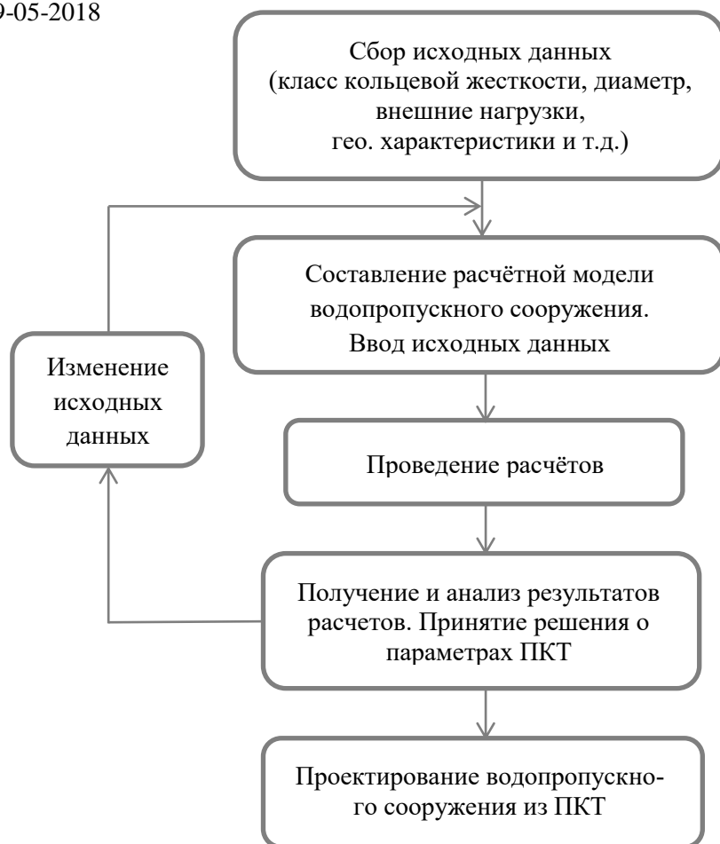
Блок-схема определения относительных деформаций ПКТ под транспортной насыпью.
