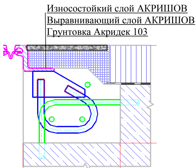
Рисунок 3 – Конструкция переходной зоны АКРИШОВ
