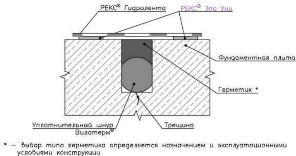
Схема ремонта трещины «Преобразование в шов»
