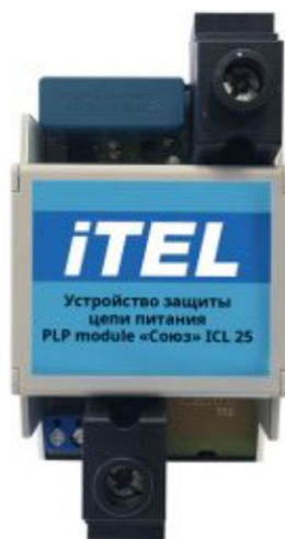
Рисунок 11 – Внешний вид устройства защиты цепи питания (PLP module) «Союз»
