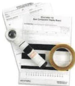
Рисунок 9 - Набор для определения запыленности согласно [18]
