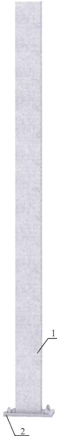
Рисунок А.1 – Фасадная часть стойки из армированного бетона с закладной деталью.
