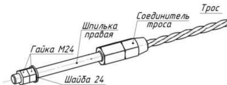
Рисунок В.10 – Крепление тросов к якорным узлам
