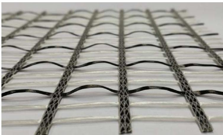
Рисунок Б.3 - Георешетка противоэрозионная «СЛАВРОС СБНП 3D»
