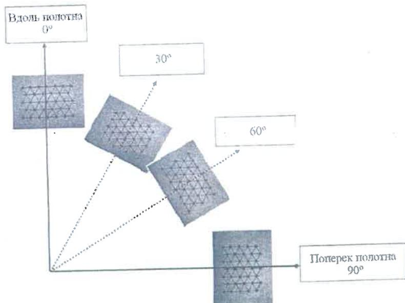
Рисунок 1 - Схематическое изображение направлений вырезки образцов
