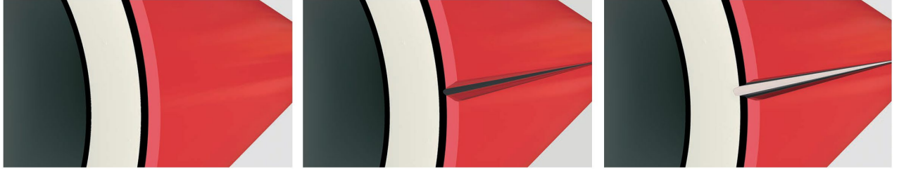
Рисунок 5.4. Степень повреждения трубы:
