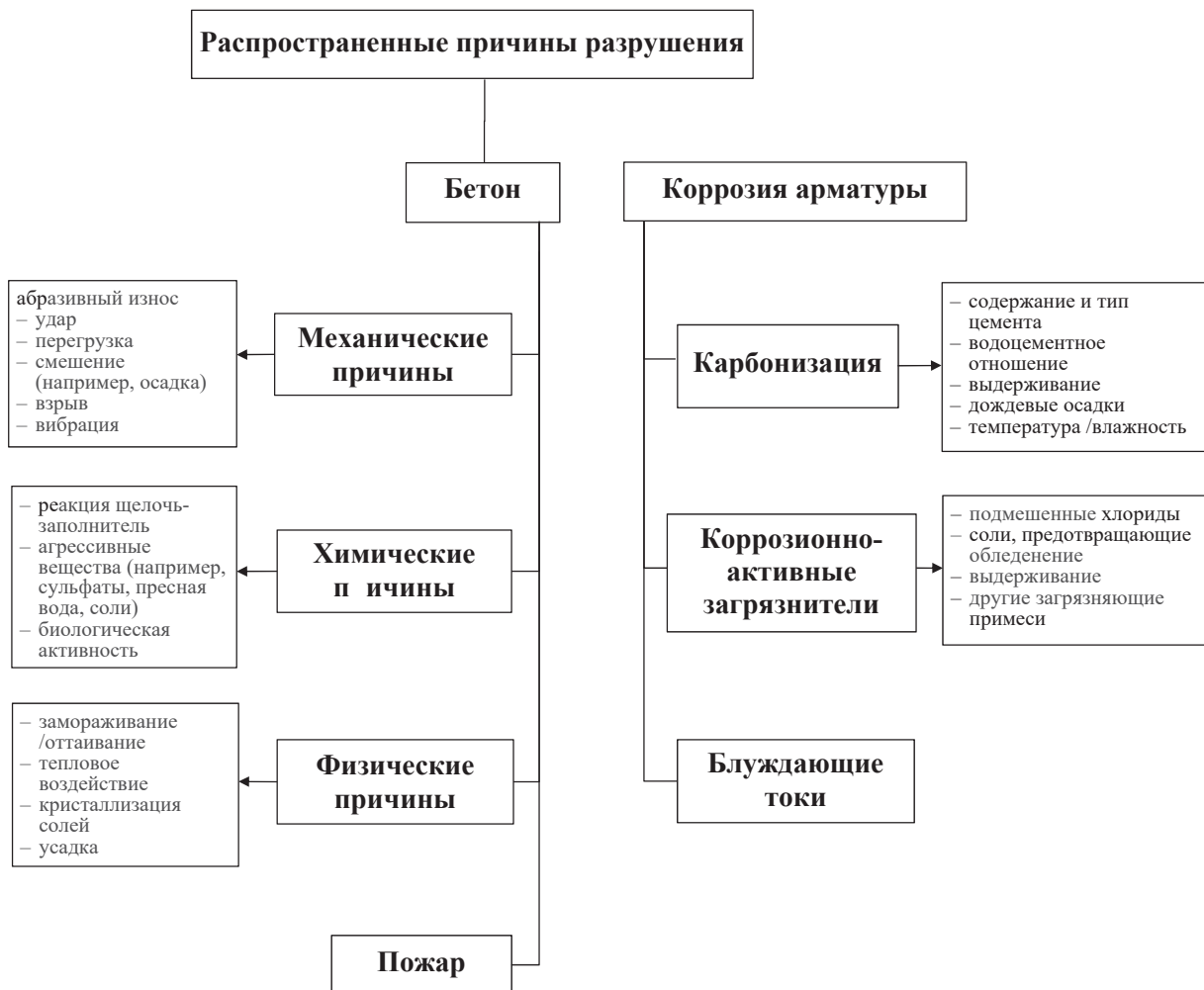
Рисунок 5.2 — Распространенные причины разрушений конструкций (ГОСТ 32016)
