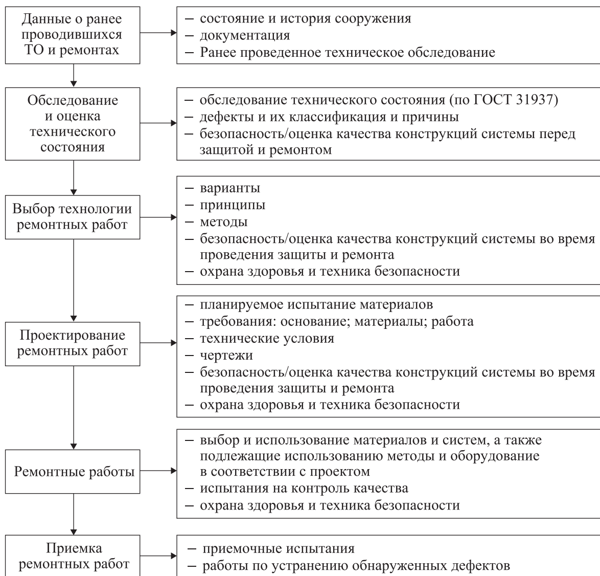
Рисунок 5.1 — Этапы стандартного проекта по ремонту конструкций
