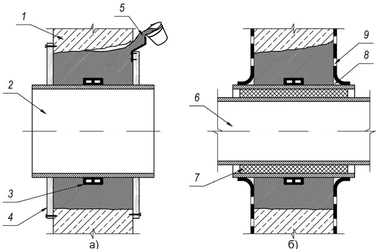
1 - строительная конструкция; 2 - стальная гильза; 3 - набухающий профиль;
