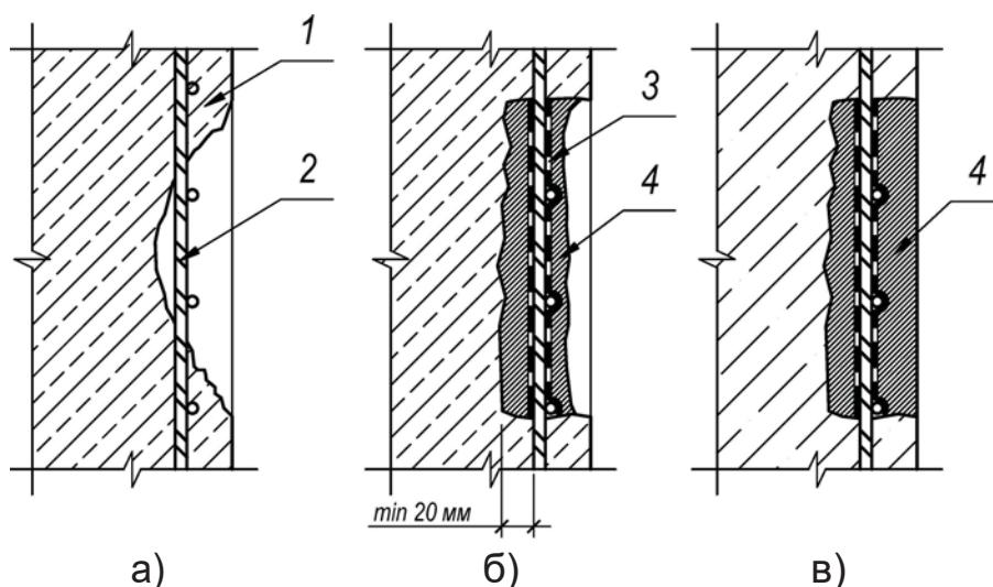
а) дефект строительной конструкции с оголением арматуры; б), в) вскрытие и ремонт дефекта
