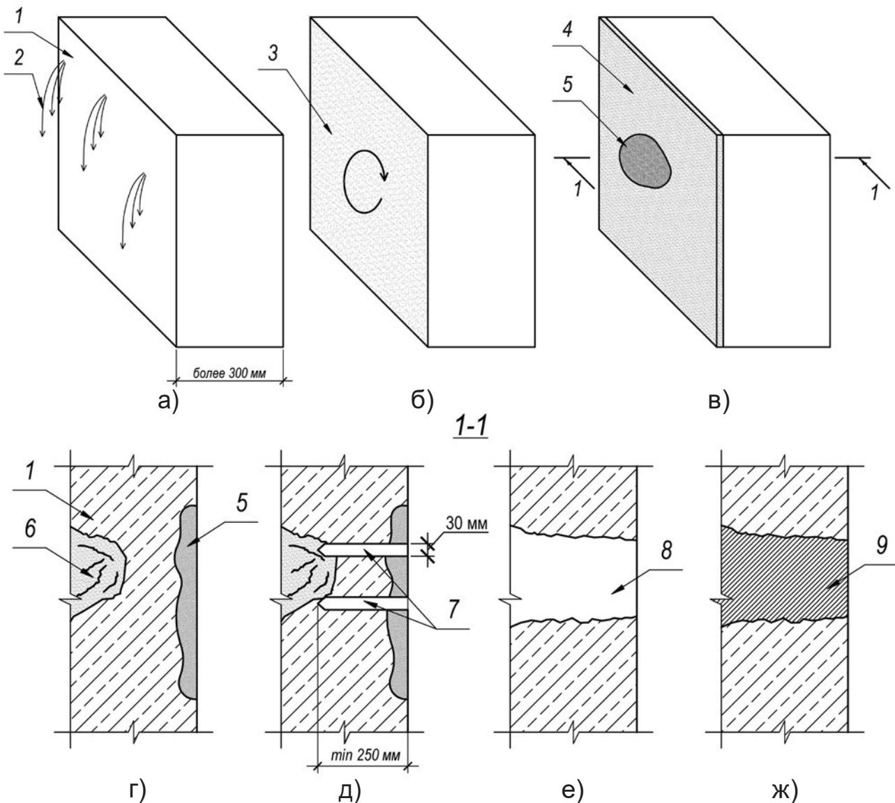
1 - бетонная конструкция; 2 - фильтрация воды через поверхность; 3 - «БАУБЕРГ 444» (втирается сухая смесь); 4 - «БАУБЕРГ 440»; 5 - мокрое пятно; 6 - скрытый дефект; 7 - отверстия для определения границ дефекта; 8 - вскрытый дефект; 9 - «БАУБЕРГ 125»
