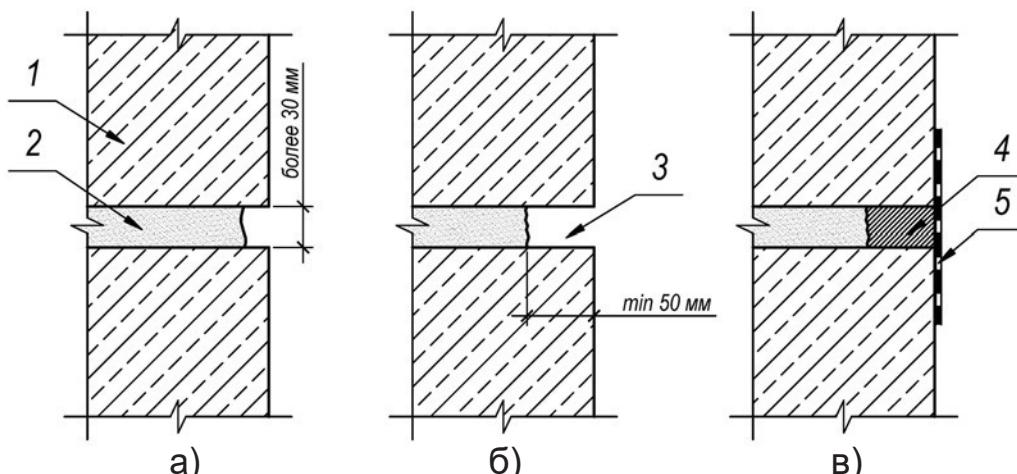
а) шов шириной более 30 мм; б) расшивка шва; в)
