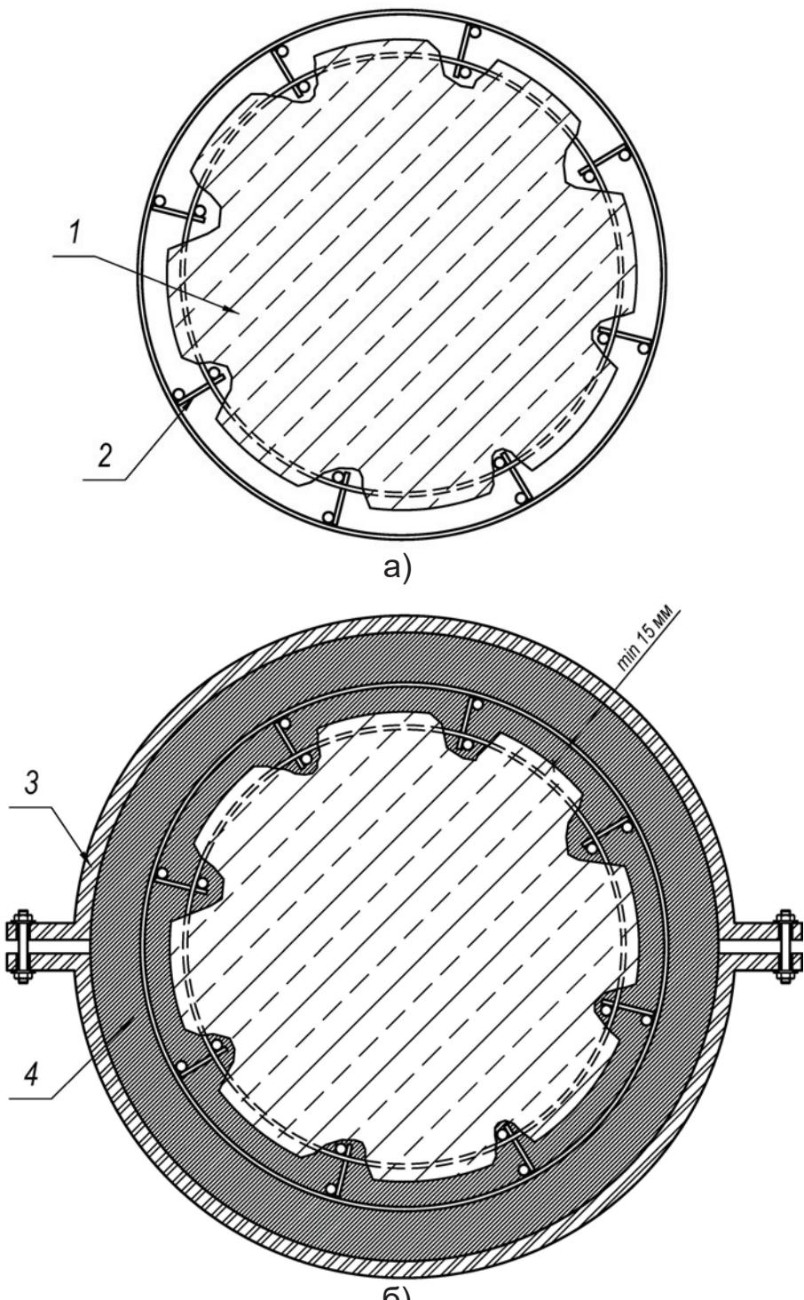
а) удаление бетона вокруг арматуры, установка дополнительной арматуры;
