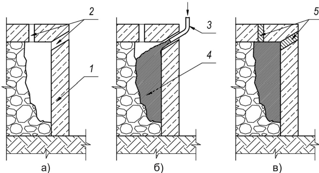
а) устройство воздухоотводящего и заливочного отверстий; б) подача литьевого материала; в) зачеканка отверстий
