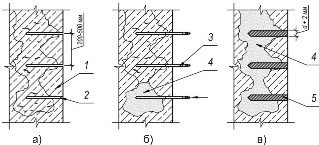
а) бурение шпуров; б) нагнетание инъекционного раствора; в) заделка
