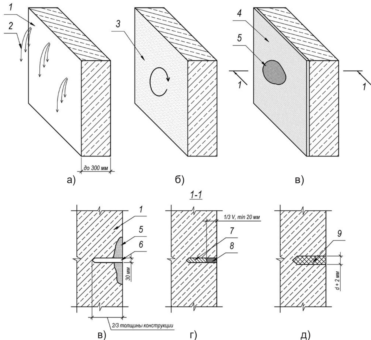
а) фильтрация воды через бетонную конструкцию; б), в) устранение фильтрации; г) мокрое пятно на поверхности конструкции;
