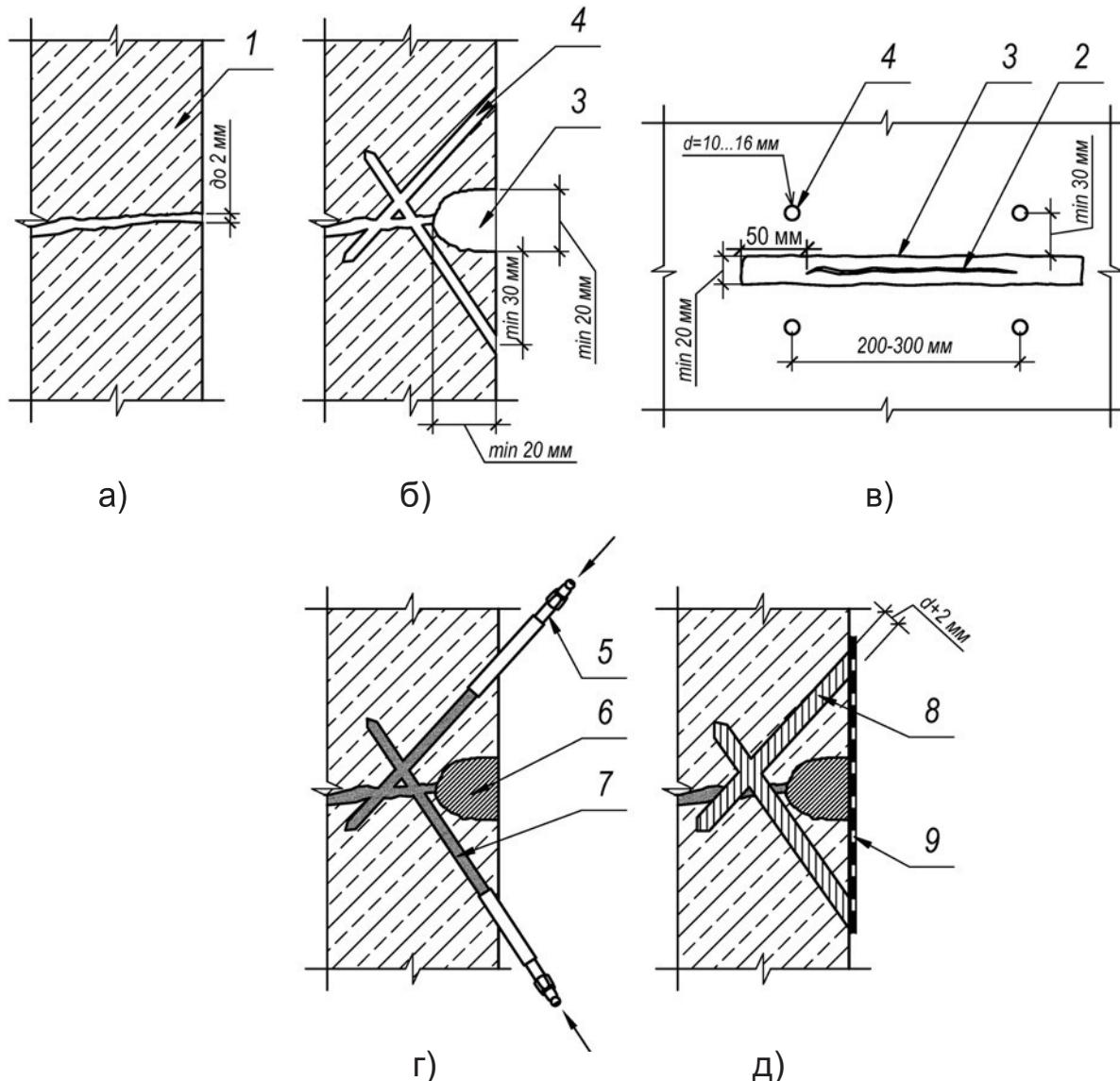
а) активная трещина; б) удаление разрушенного бетона, сверление шпуров; в) схема сверления шпуров; г) установка пакеров, заполнение штрабы раствором, нагнетание смолы; д) сверление отверстий из под пакеров, зачеканка отверстий раствором, нанесение гидроизоляции 1 - строительная конструкция; 2 - трещина; 3 - штраба; 4 - шпуры;
