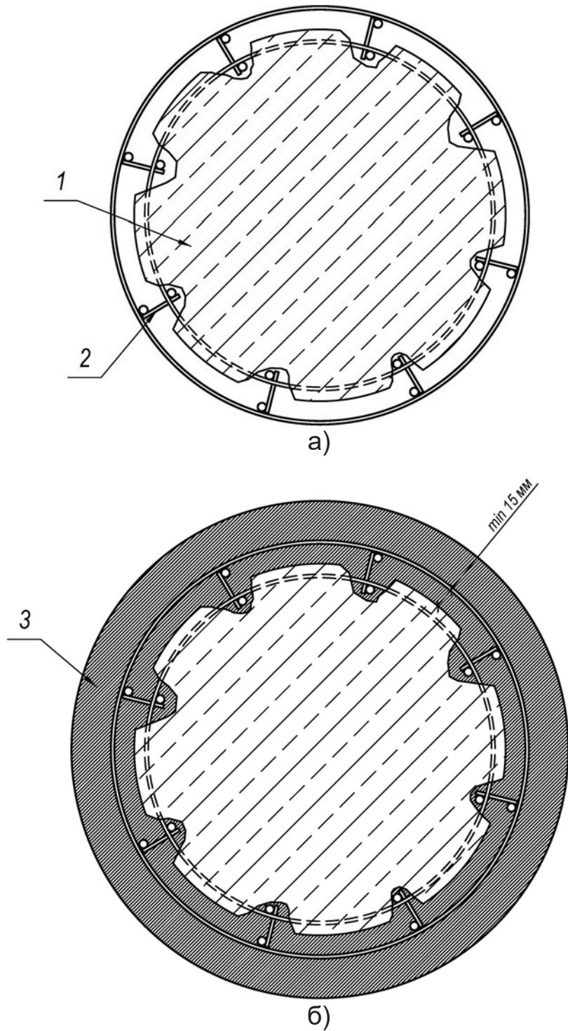
а) удаление бетона вокруг арматуры, установка дополнительной арматуры; б)
