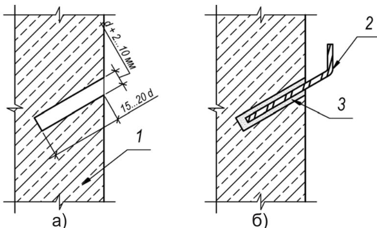
а) сверление отверстия; б) установка и цементация арматуры 1 - бетонная конструкция; 2 - арматура; 3 - «БАУБЕРГ 546»
