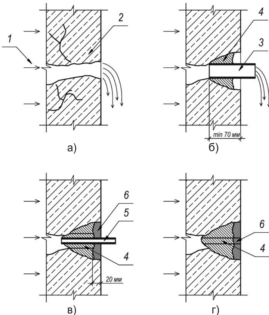
а) активная протечка; б), в) метод колец; г) герметизация полости 1 - вода; 2 - строительная конструкция; 3 - первая водоотводящая трубка; 4 - «БАУБЕРГ 444»; 5 - последующие водоотводящие трубы меньшего диаметра; 6 - «БАУБЕРГ 123» или «БАУБЕРГ 125»
