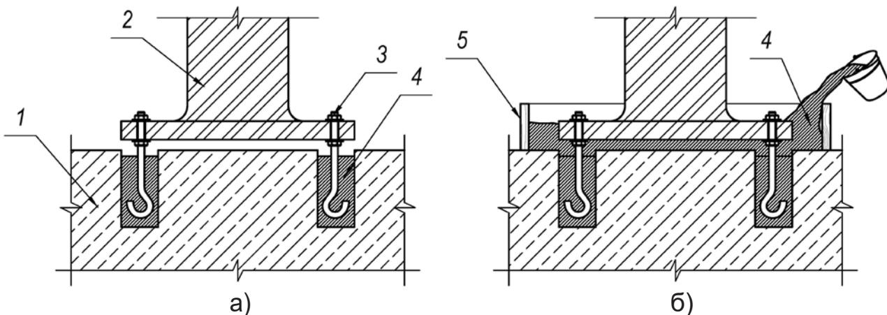
а) омоноличивание анкеров, б) установка опалубки и заливка литьевого материала
