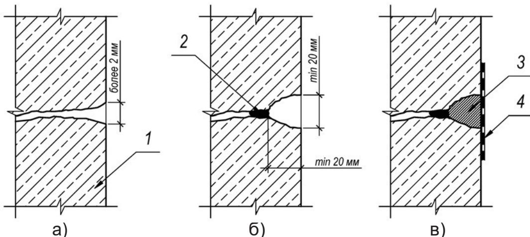
а) трещина с шириной раскрытия более 2 мм; б) расшивка трещины, заполнение трещины внутри штрабы;
