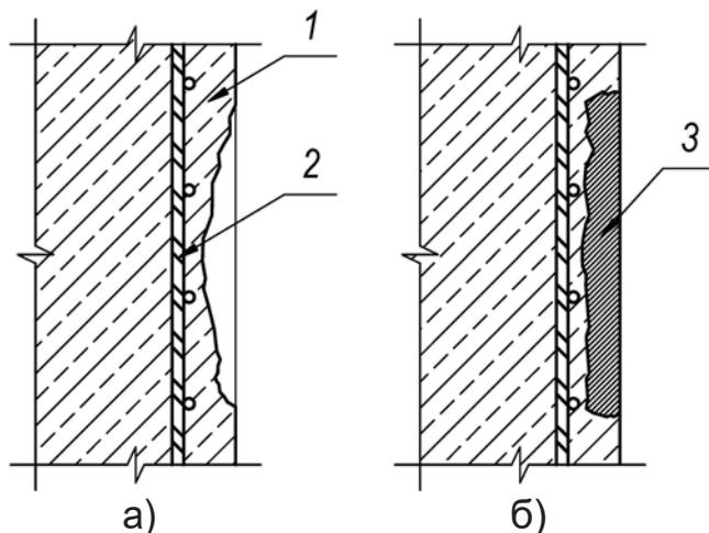
а) дефект строительной конструкции без оголения арматуры; б) вскрытие и ремонт дефекта
