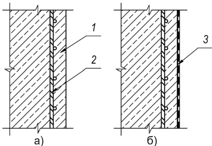
а) бетонная конструкция; б) нанесение гидроизоляции
