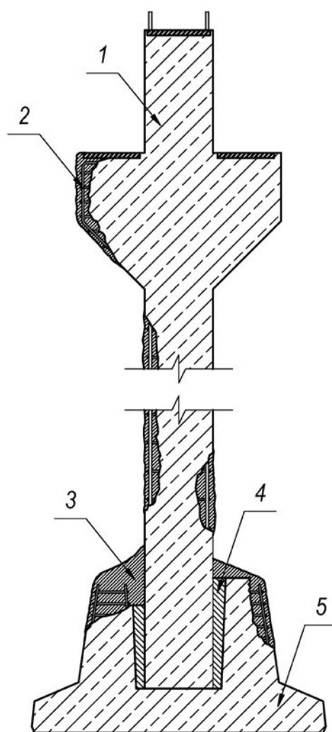
1 - железобетонная колонна; 2 - оголенная арматура; 3 - «БАУБЕРГ Торкрет С» или «БАУБЕРГ Торкрет М»; 4 - «БАУБЕРГ 226»; 5 - железобетонный подколонник
