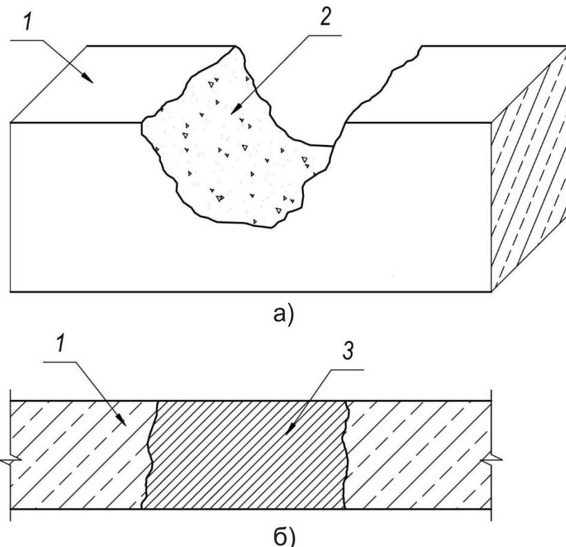
а) дефект глубиной до 60 мм; б) ремонт дефекта 1 - элемент конструкции; 2 - поверхность скола; 3 - «БАУБЕРГ 123» или «БАУБЕРГ 125»
