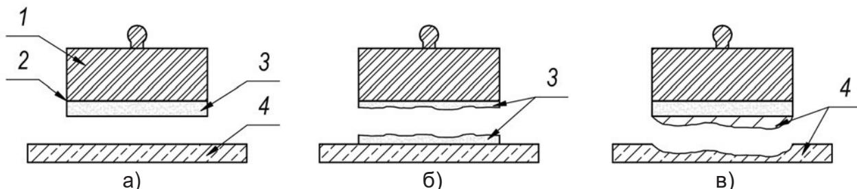
1 – металлический штамп; 2 – клей; 3 – образец; 4 – бетонная плита (основание)
