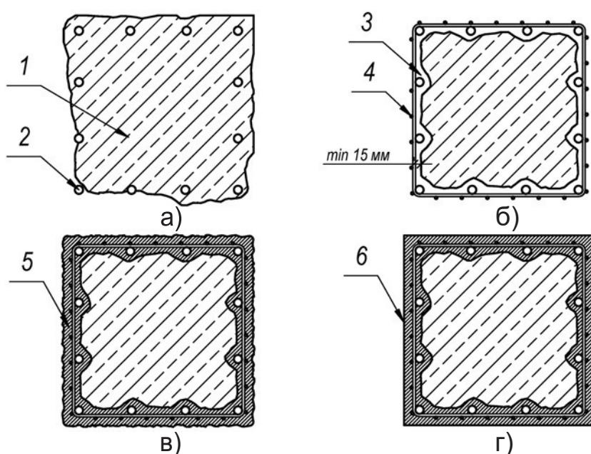
а) колонна с дефектом; б) удаление бетона вокруг арматуры, установка дополнительной арматуры; в) торкретирование;
