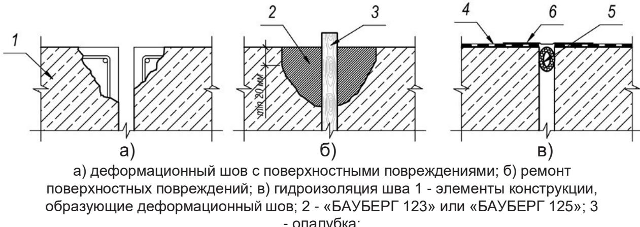
Рисунок 5.11 – Ремонт деформационного шва
