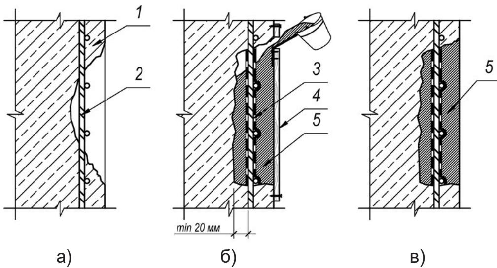
а) дефект строительной конструкции с оголением арматуры; б), в) вскрытие и ремонт дефекта
