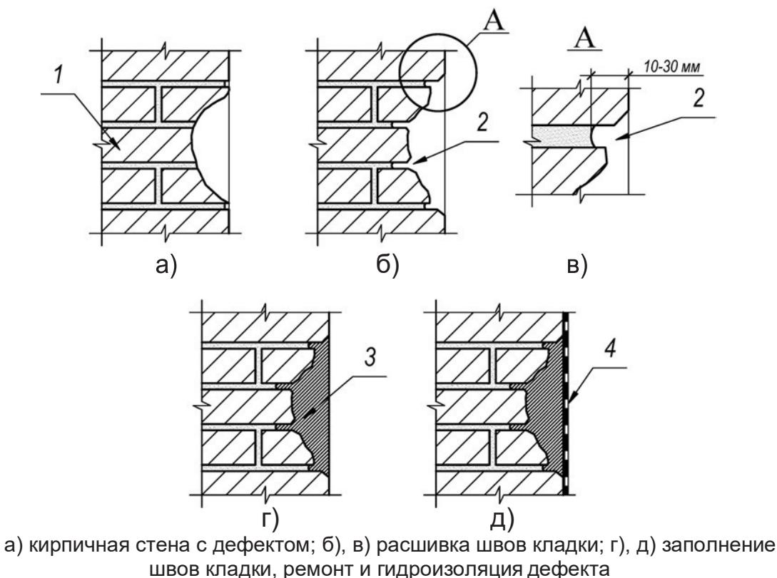
а) кирпичная стена с дефектом; б), в) расшивка швов кладки; г), д) заполнение швов кладки, ремонт и гидроизоляция дефекта
