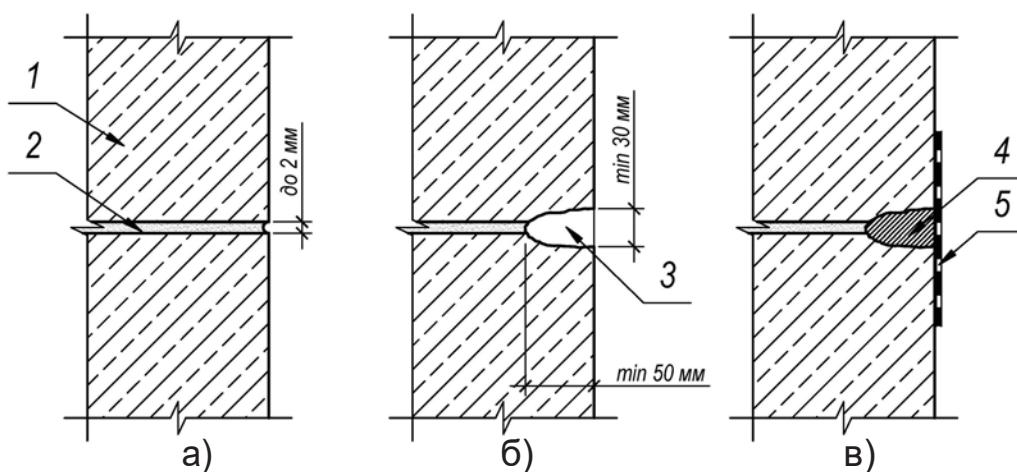
а) шов шириной до 2 мм; б) расшивка шва;
