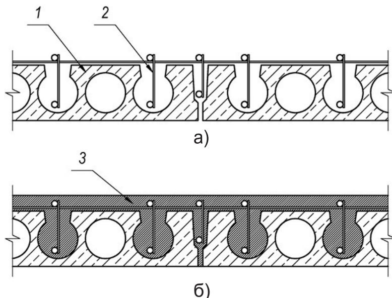
а) удаление бетона вокруг арматуры, установка дополнительной арматуры; б) заливка литьевого материала
