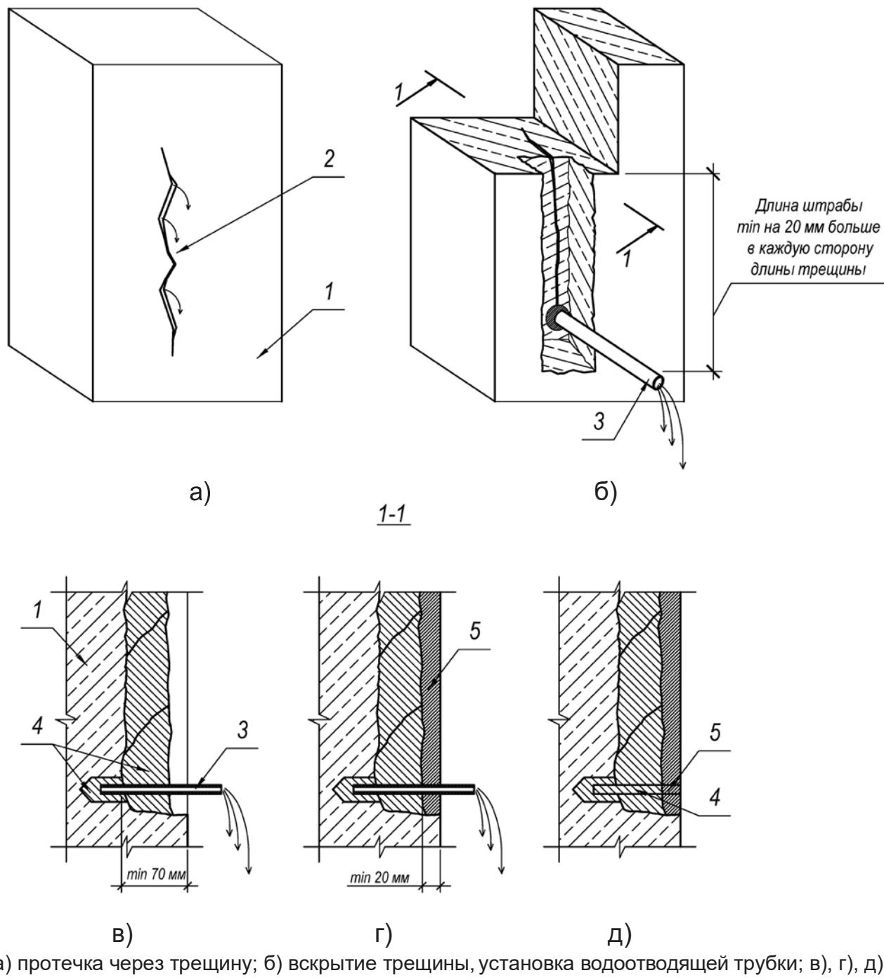
а) протечка через трещину; б) вскрытие трещины, установка водоотводящей трубы; в), г), д) устранение протечки
