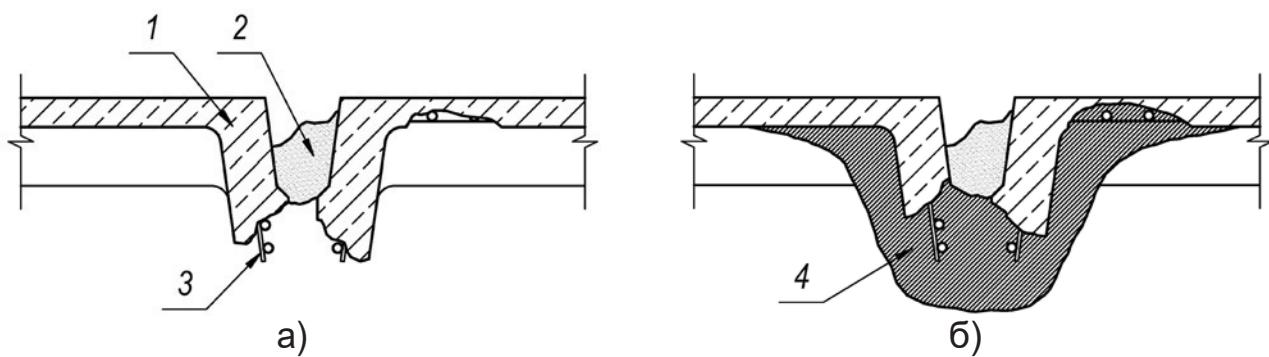
а) ребристая плита перекрытия с дефектами; б) ремонт дефекта; 1 - ребристая плита перекрытия; 2 - старый раствор; 3 - оголенная арматура; 4 - «БАУБЕРГ Торкрет С» или «БАУБЕРГ Торкрет М»
