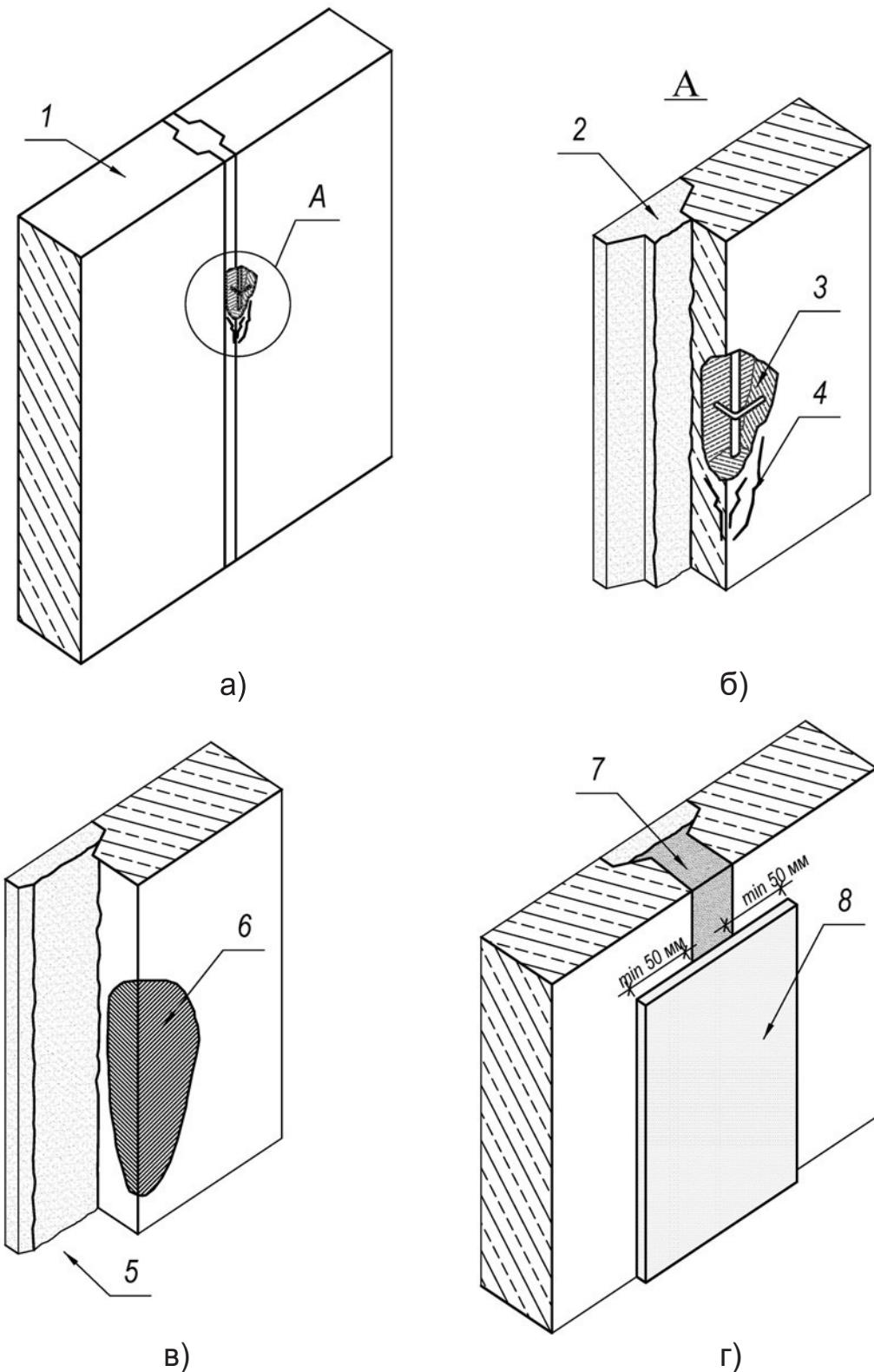
а) шов с дефектами; б) дефекты элементов, образующих шов; в) ремонт дефектов; г) заполнение и гидроизоляция шва
