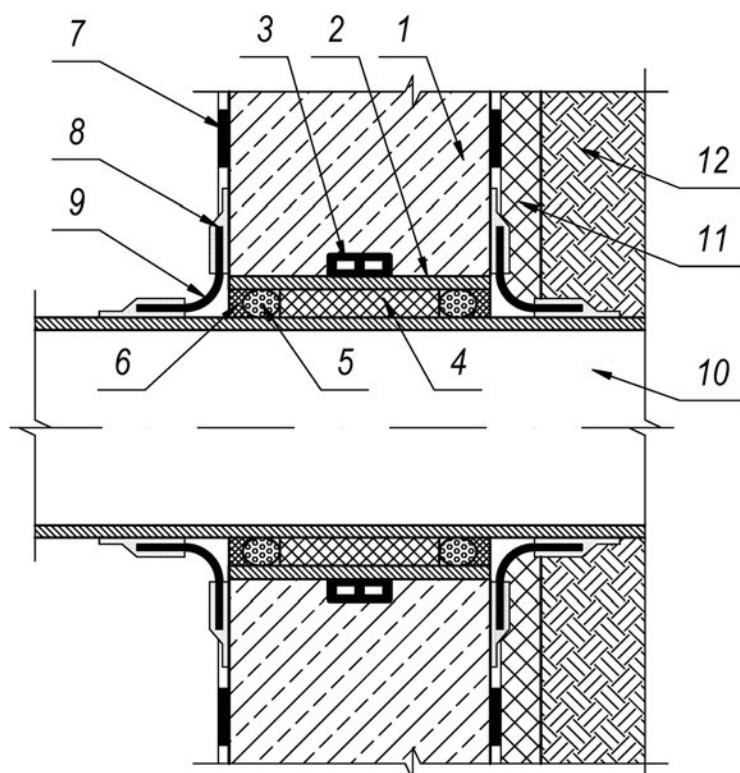
1 - железобетонная конструкция; 2 - стальная гильза; 3 - набухающий профиль; 4 - монтажная пена;
