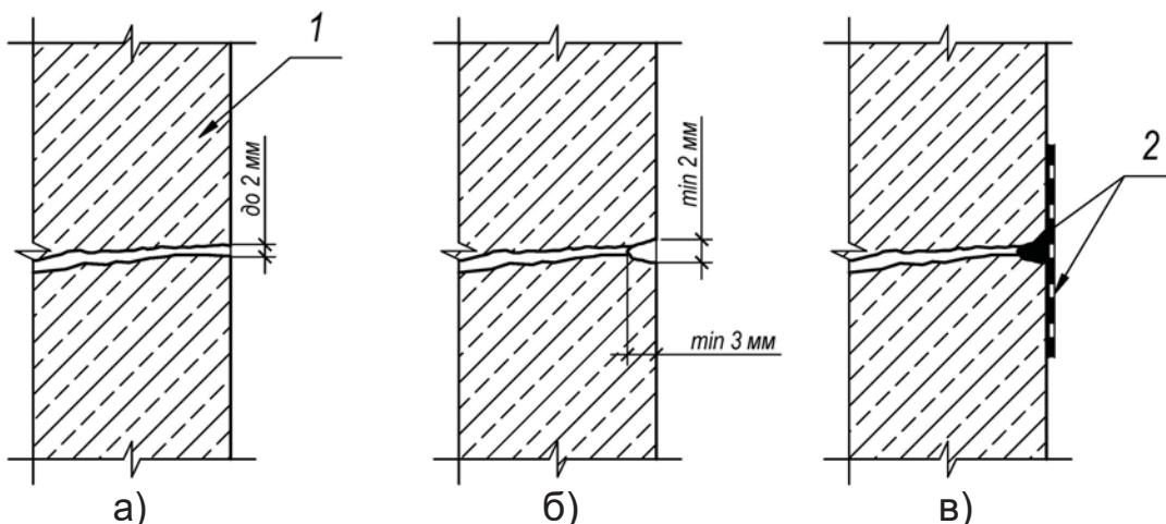
а) трещина с шириной раскрытия до 2 мм; б) расшивка трещины;
