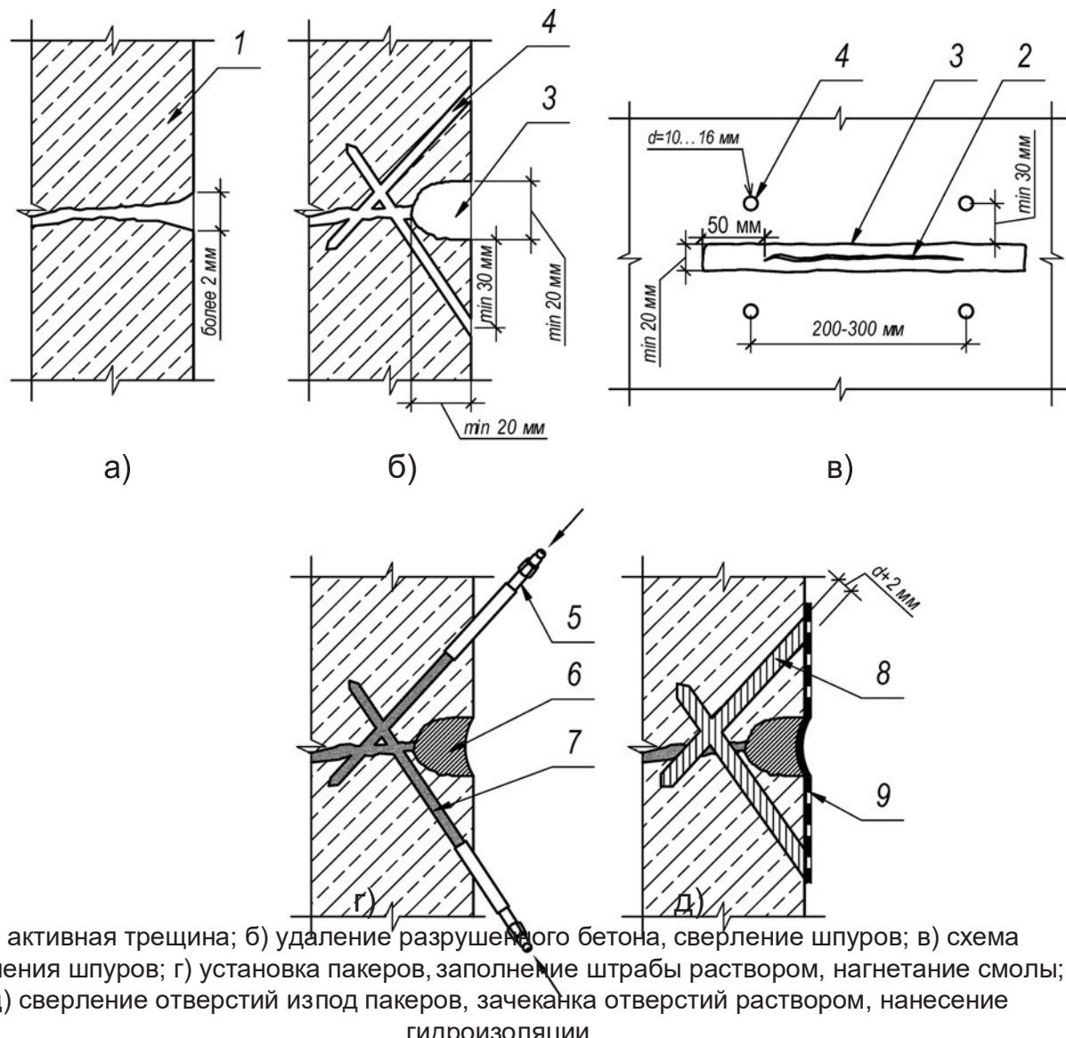
Рисунок 5.20 - Герметизация активных трещин при ширине раскрытия свыше 2 мм
